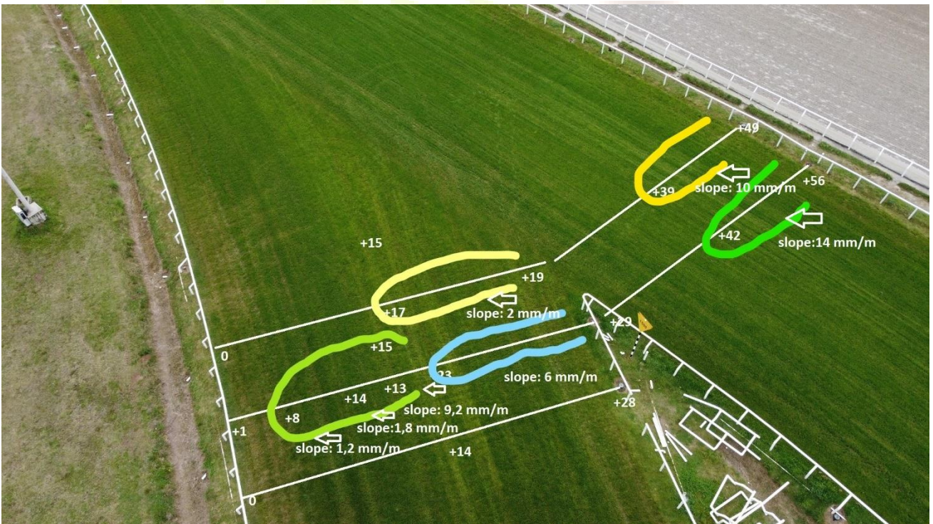
Figura 8: Cambios de la pendiente a 2 m de la baranda interior del boquerón.
