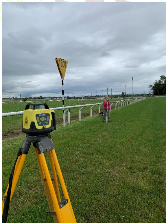
Figura 6: Nivel Laser rotativo FRE203 Geo-Allen®(Suzhou, Jiangsu, Shangai)
