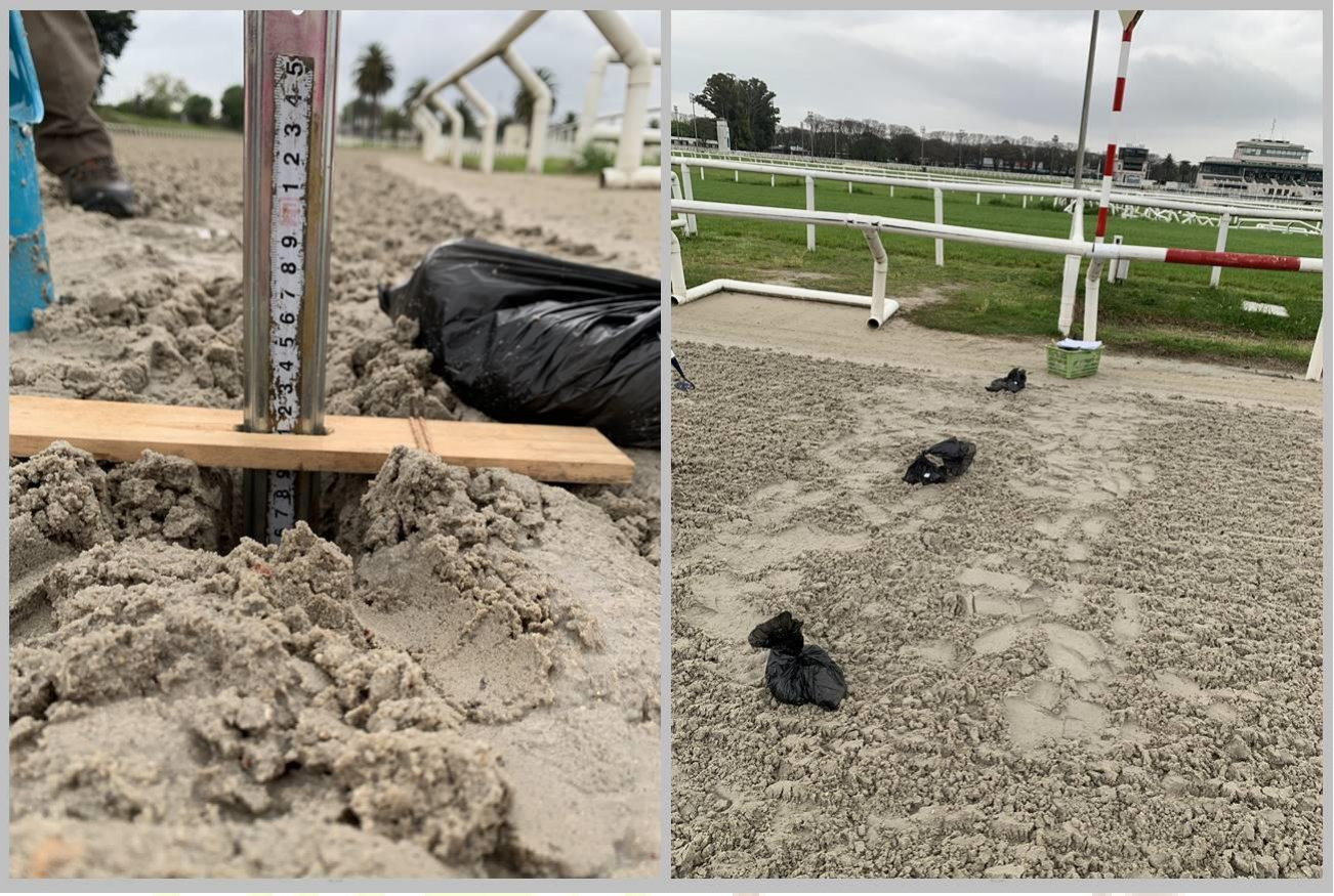
Figura 11 y 12: Espesor de amortiguación y ubicaciones radiales de las mediciones y del muestreo.
